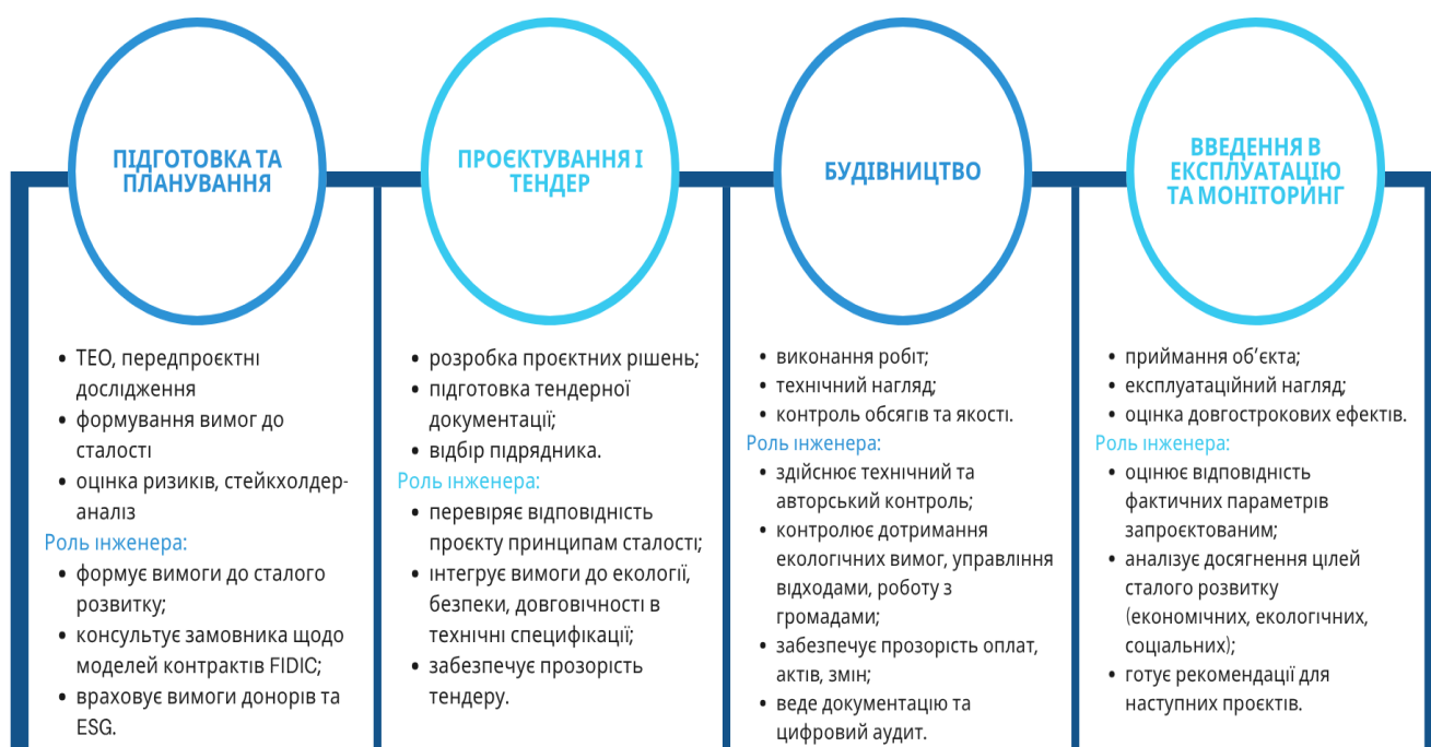
Рис. 1. Місце інженера-консультанта в інтеграції принципів сталого розвитку на етапах життєвого циклу інфраструктурного проєкту
